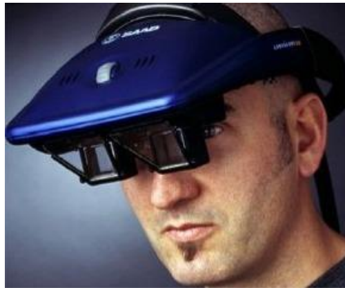
Figura 15. Exemplo de HMD translúcido
