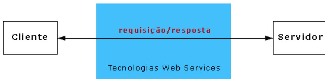
Figura 8. Esquema de funcionamento de um *Web Service*
