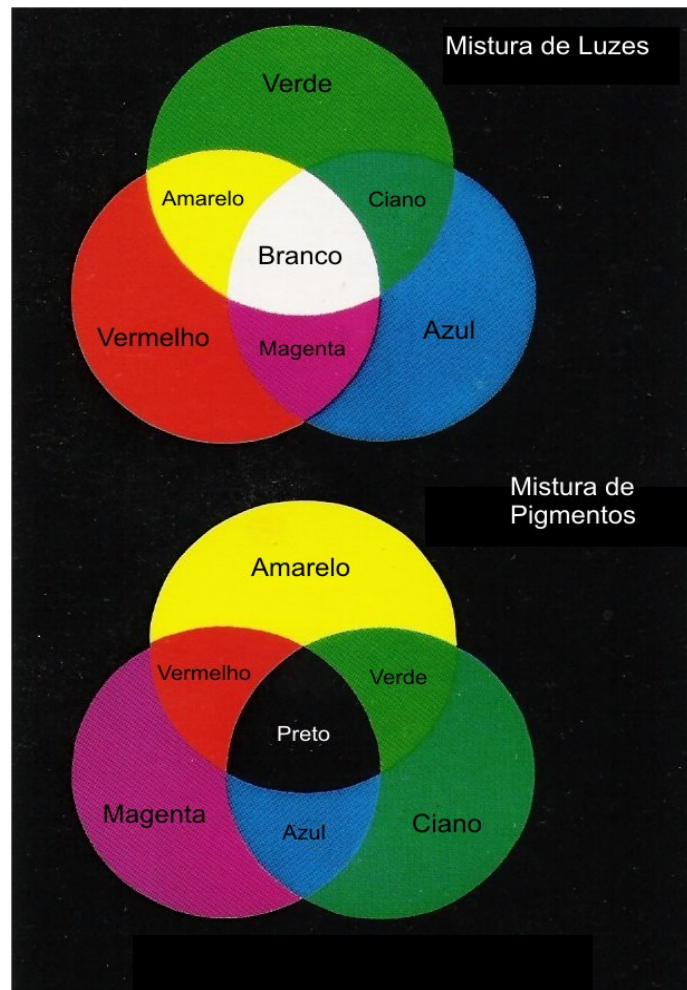
Figura 12. Cores primárias e secundárias da luz e dos pigmentos. (Figura retirada do livro “Digital Image Processing”, R. GONZALEZ e , P. WINTZ, ed. Addison-Wesley Publishing Company, Inc., 2ª edição, 1987)
