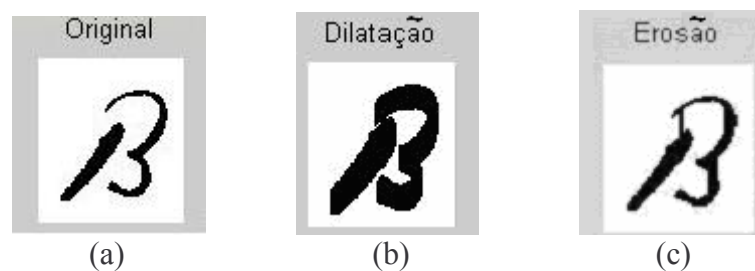
Figura 21. Exemplo de aplicação de filtros morfológicos utilizando as funções do Matlab: em (a) apresenta a imagem original, em (b) a aplicação da função imdilate e ao resultado foi aplicada a função imerode (c).
