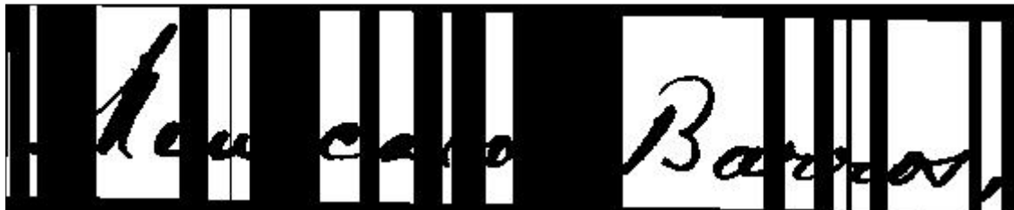
Figura 29. Exemplo de imagem com fragmentos de caracteres que podem ser identificados erradamente. Neste caso temos a segmentação da letra u em dois glyphs .
