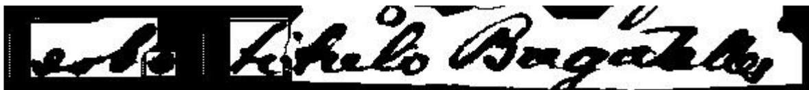
Figura 53. Exemplo de palavras unidas. Imagem segmentada utilizando a transformada de watershed com dilatação.
