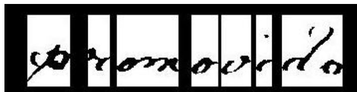
Figura 52. Exemplo de palavra quebrada em três: promovido foi segmentado em 'p', 'rom' e 'ovido'. O último segmento é um exemplo de caracteres conectados. Imagem segmentada utilizando a análise de projeção.
