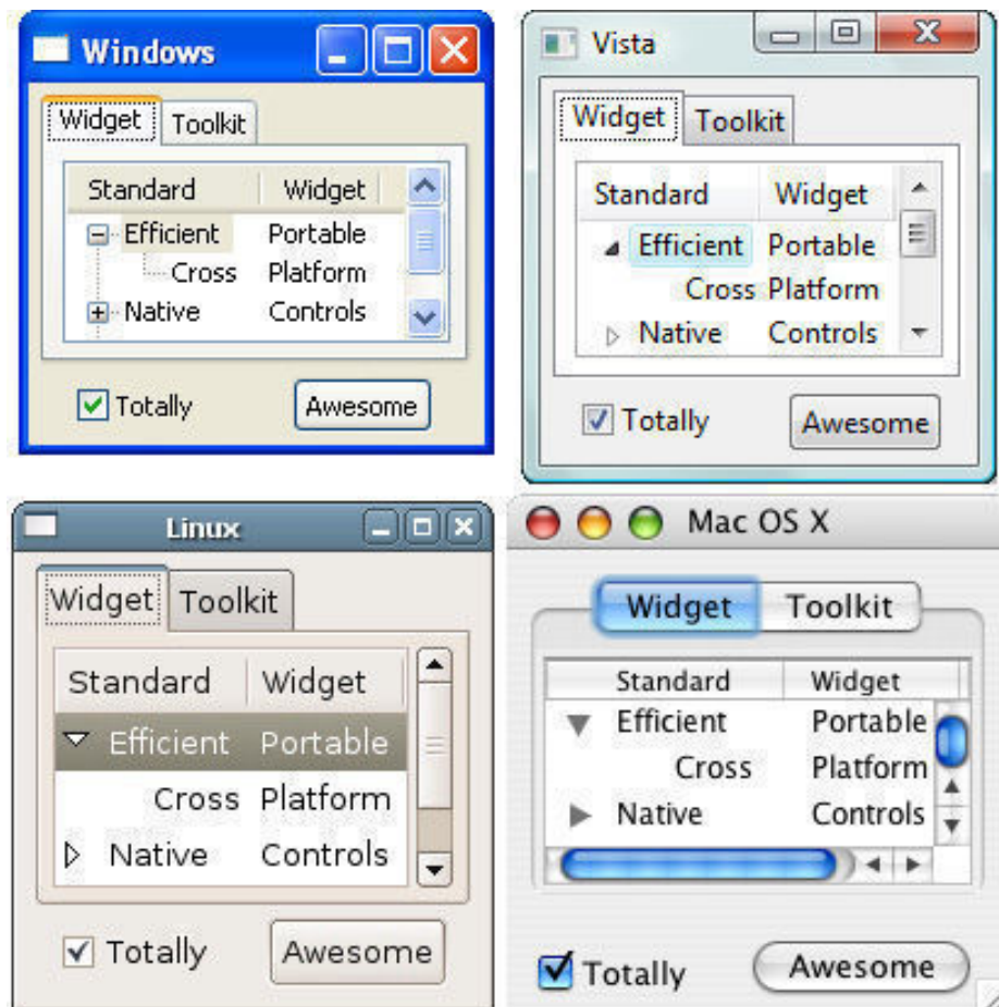
Figura 2-3 Comportamento dos componentes gráficos de uma aplicação SWT ao ser executada em diversos sistemas operacionais.
