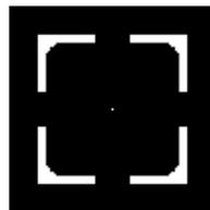
**Figura A.3** - resultado da aplicação da operação erosão sobre os operandos vindos da Figura A.1.
