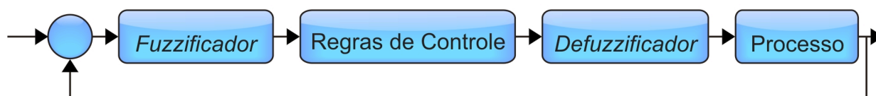
Figura 10. Ilustração em blocos do controlador Fuzzy proposto por Mamdani.
