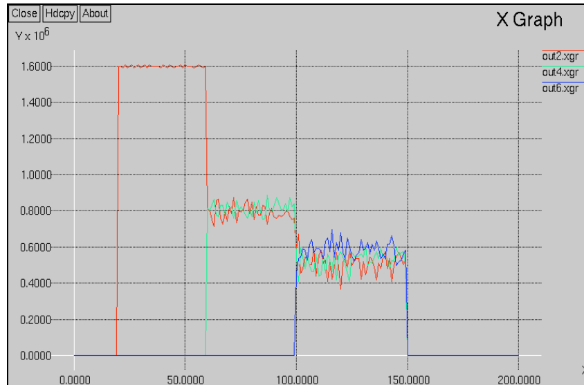
Figura 13. Gráfico de vazão gerado pelo script de validação da análise de vazão [22].
