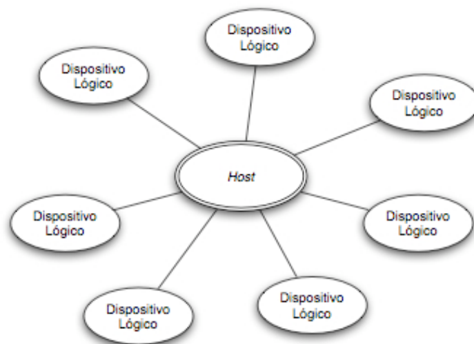
Figura 10. Topologia Lógica da ponte USB [26].
