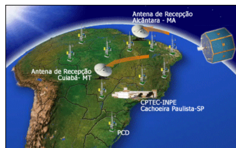
Figura 14. Transmissão de dados entre satélite e antena de recepção
