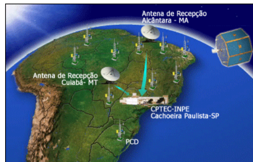
Figura 15. Transmissão de dados entre antenas de recepção e centro de missão de coleta
