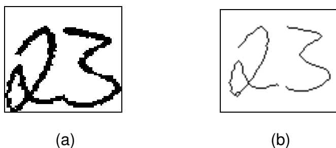
Figura 10. Exemplo de aplicação da segmentação de caracteres, (a) imagem original: dígitos conectados (b) dígitos segmentados corretamente.
