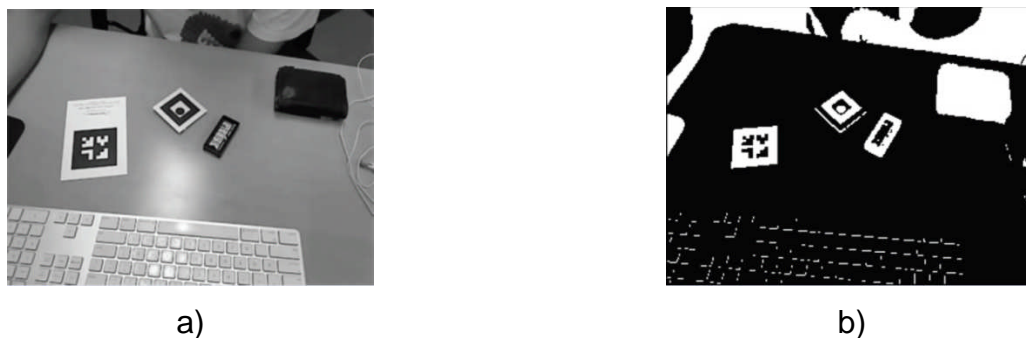
Figura 4.2. Binarização: a) Imagem em escala de cinza; b) Imagem após binarização
