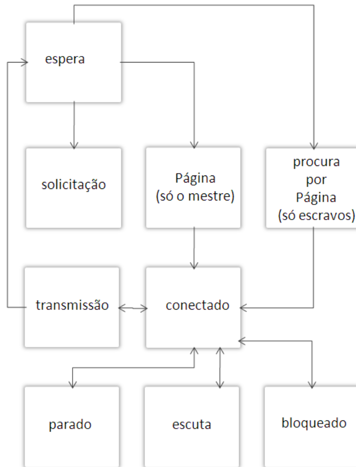
Figura 5. Máquina de estados de um dispositivo Bluetooth .
