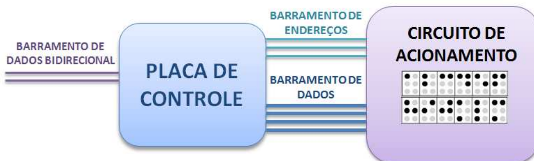
Figura 31. Arquitetura do Hardware do KnowTouch.
