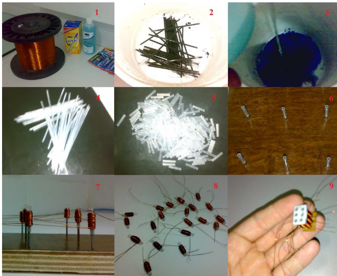
Figura 39. Resumo do processo de fabricação de uma cela Braille. (1) Materiais utilizados; (2) Cargas de canetas esferográficas; (3) Remoção da tinta das cargas de canetas com acetona; (4) Cargas de canetas sem tinta; (5) Cargas cortadas em tubos de 2 cm de comprimento; (6) Fixação dos tubos em um suporte auxiliar; (7) Fio de cobre enrolado por volta de cada tubo, aproximadamente 200 voltas; (8) Remoção das bobinas do suporte auxiliar; (9) Cela Braille montada.
