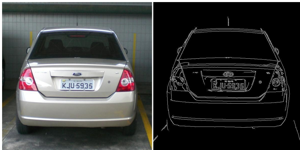
Figura 8. Detecção de borda através da função Edge , usando o método Canny
