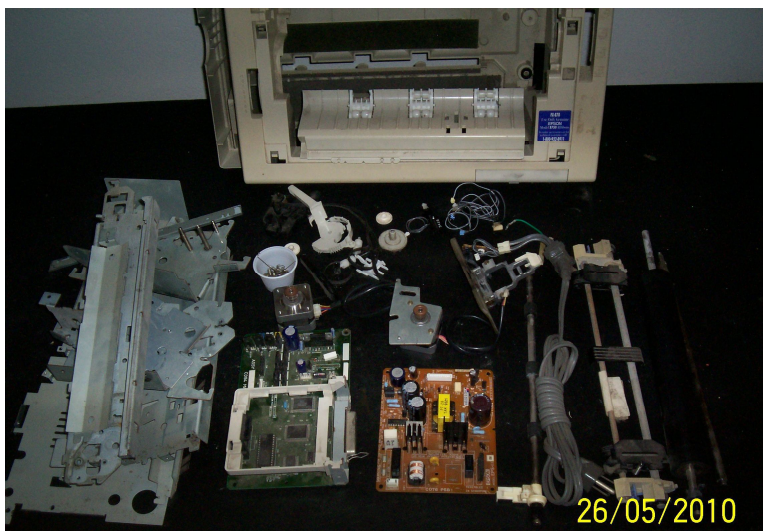
Figura 11. Impressora FX 870 desmontada
