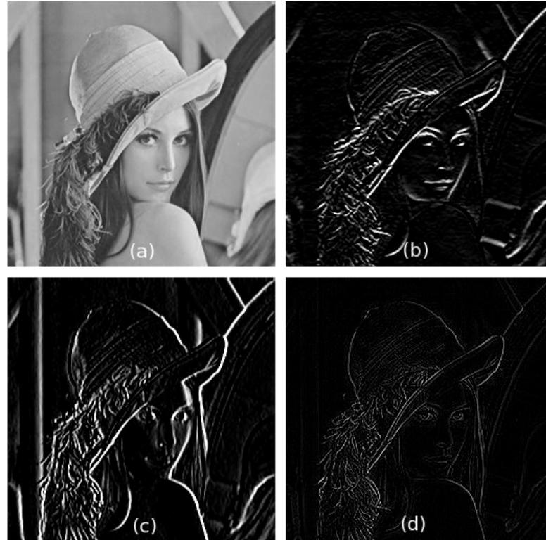
*Figura 10: Filtros de detecção de borda. (a) representa a imagem original. Em (b) filtro de Sobel horizontal, em (c) filtro de Sobel vertical e em (d) filtro laplaciano.*
