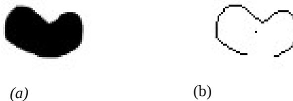
Figura 32: Detecção de um objeto irregular detectado em (b) a partir de (a).
