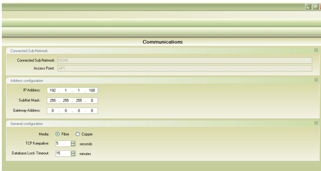
**Figura 18.** Configuração da comunicação com o relé.
