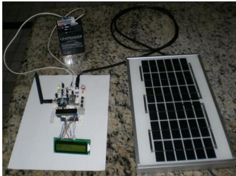
**Figura 5.5** – Plataforma completa de *hardware* sendo alimentada com bateria recarregada com painel solar.
