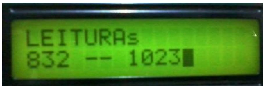
Figura 5.4 – Display LCD com valor de leitura do canal ADC.
