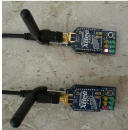
Figura 5.6 – Módulos XBee conectados ao adaptador USB-XBee.
