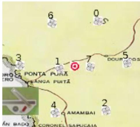
Figura 6.6: Hexágono regular, contendo dois UAVs e o alvo em seu centro, formado por oito UAVs em estado de rastreamento.
