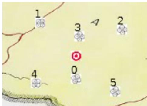
Figura 6.4: Hexágono simétrico não regular, contendo o alvo em seu centro, formado por quatro UAVs em estado de rastreamento.
