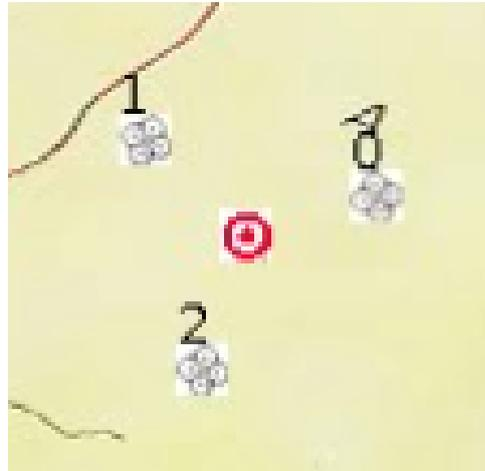
Figura 6.1: Triângulo equilátero, contendo o alvo em seu centro, formado por três UAVs em estado de rastreamento.
