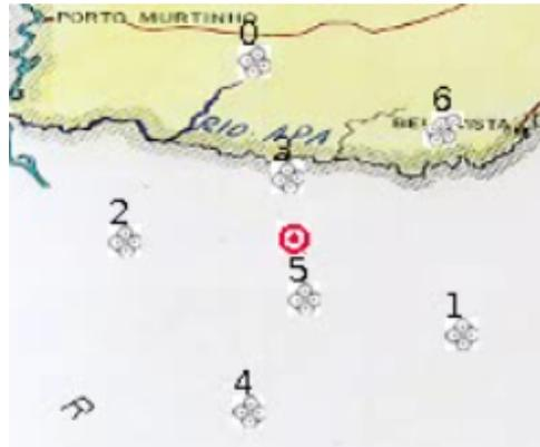
Figura 6.5: Pentágono regular, contendo dois UAVs e o alvo em seu centro, formado por sete UAVs em estado de rastreamento.
