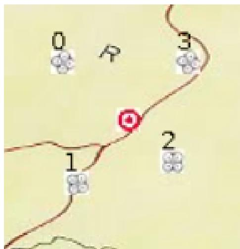
Figura 6.2: Quadrado, contendo o alvo em seu centro, formado por quatro UAVs em estado de rastreamento.
