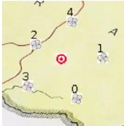
Figura 6.3: Pentágono regular, contendo o alvo em seu centro, formado por quatro UAVs em estado de rastreamento.
