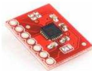
**Figura 13 - Placa com giroscópio ITG-3200 utilizado no projeto AeroQuad.**
