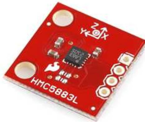
Figura 10 - Placa de sensoriamento com magnetômetro HMC5883L utilizada o projeto AeroQuad.
