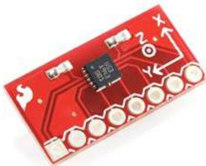
Figura 11 - Placa com acelerômetro BMA180 utilizado no projeto AeroQuad.
