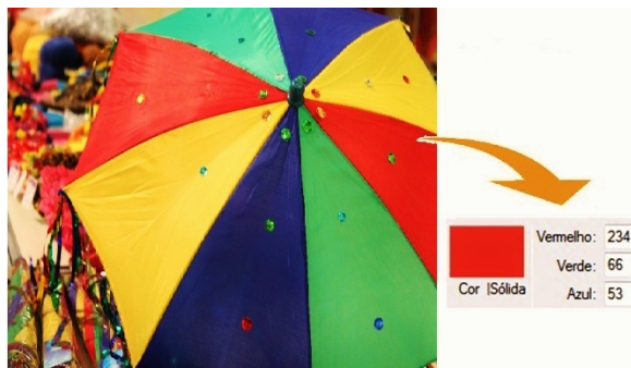
Figura 10: Ilustração da decomposição de uma cor predominantemente vermelha nas três cores primárias do RGB .
