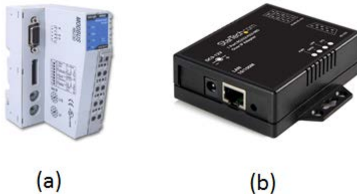
Figura 3.1 Conversores de LAN para RS-232. (a) NA-4021 (MOXA) e (b) NETRS2321E (STARTECH, 2012).
