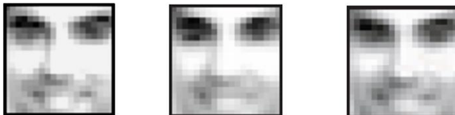
Figura 9. Imagens reconstruídas. A imagem da esquerda é a imagem original, a do meio é a imagem reconstruída pela NMF e a da direita é a imagem reconstruída pela PCA.
