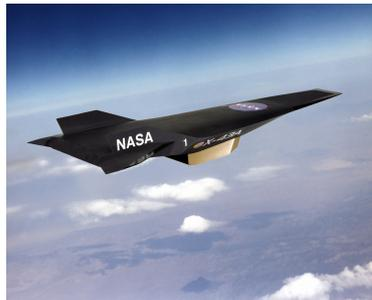
**Figura 3.2: X-43A, protótipo utilizado para testes de voo em de velocidades hipersônicas superiores à *Mach 7*.**
