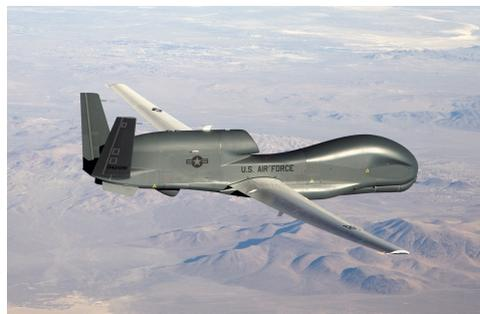
**Figura 3.1: Northrop Grumman RQ-4 Global Hawk, utilizado em missões de reconhecimento pela força aérea norte americana.**
