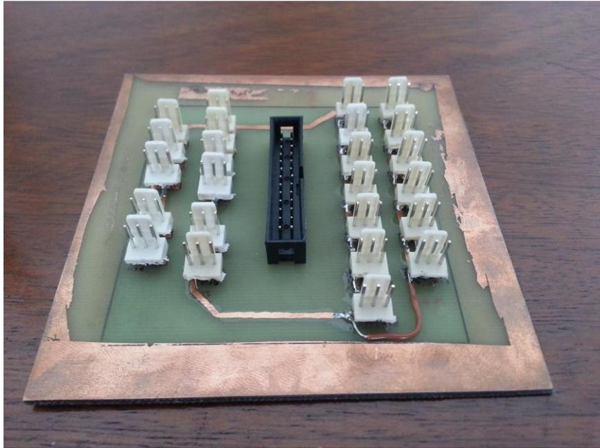
**Figura 10.** Hardware da placa de conexões.
