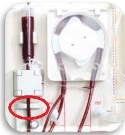
**Figura 9.** Sensor Ultrassônico numa máquina de hemodiálise.
