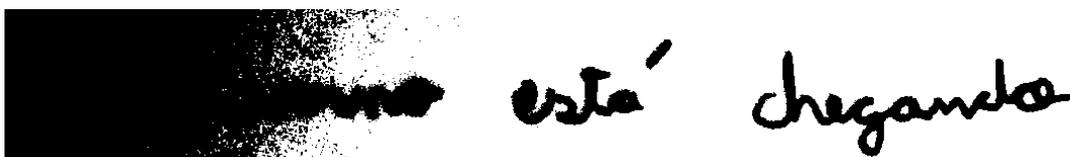
Figura 4 – Binarização da imagem apresentada em 2b utilizando a técnica de Otsu.
