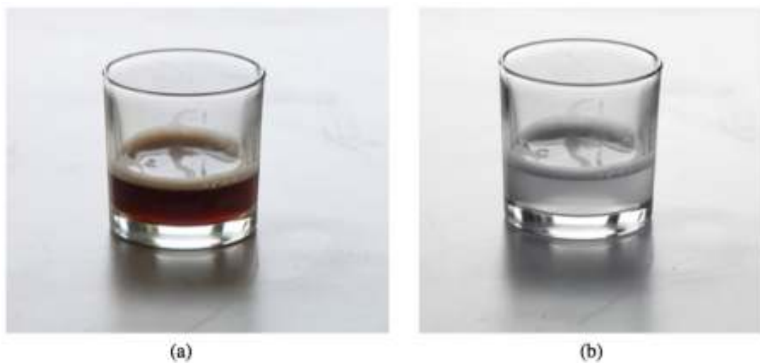
Figura 11. (a) Copo de Coca-Cola Diet com apenas com luz visível. (b) A mesma imagem, agora apenas com espectro NIR.
