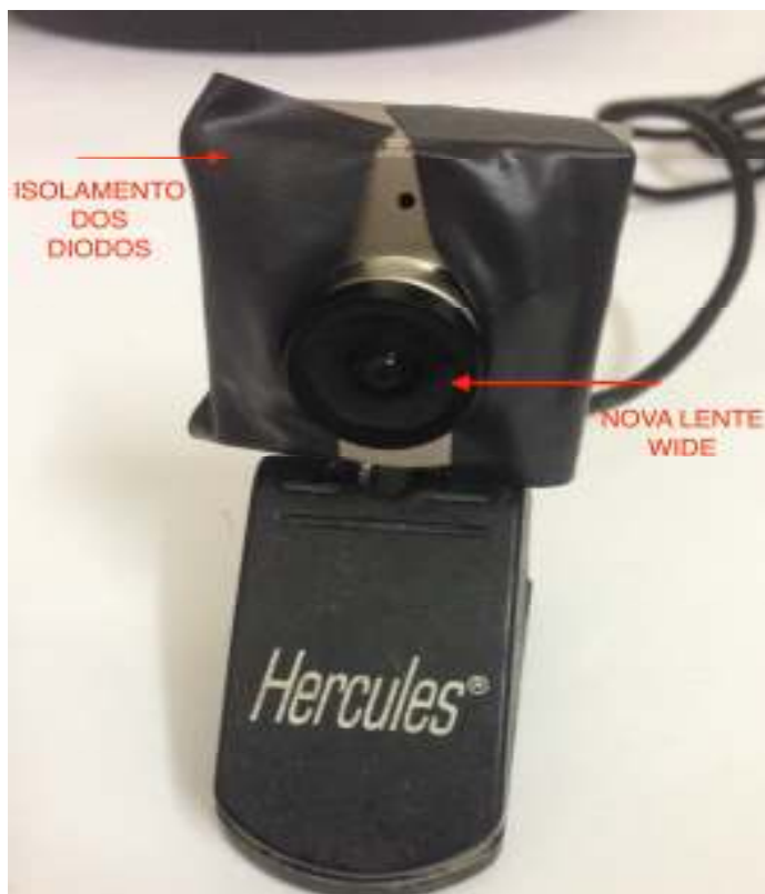
Figura 21. WebCam Hercules Optical Glass já com suas modificações.
