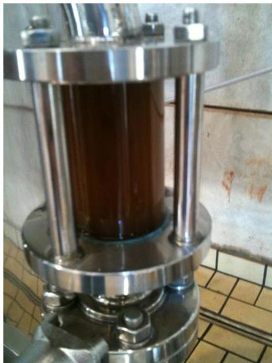
**Figura 32.** Tubo transparente com mosto passando.
