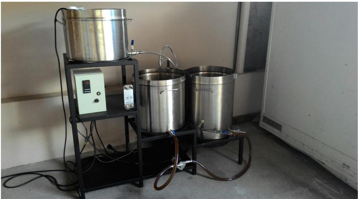
**Figura 21.** Cozinha Tribloco com fonte de calor por resistência elétrica.
