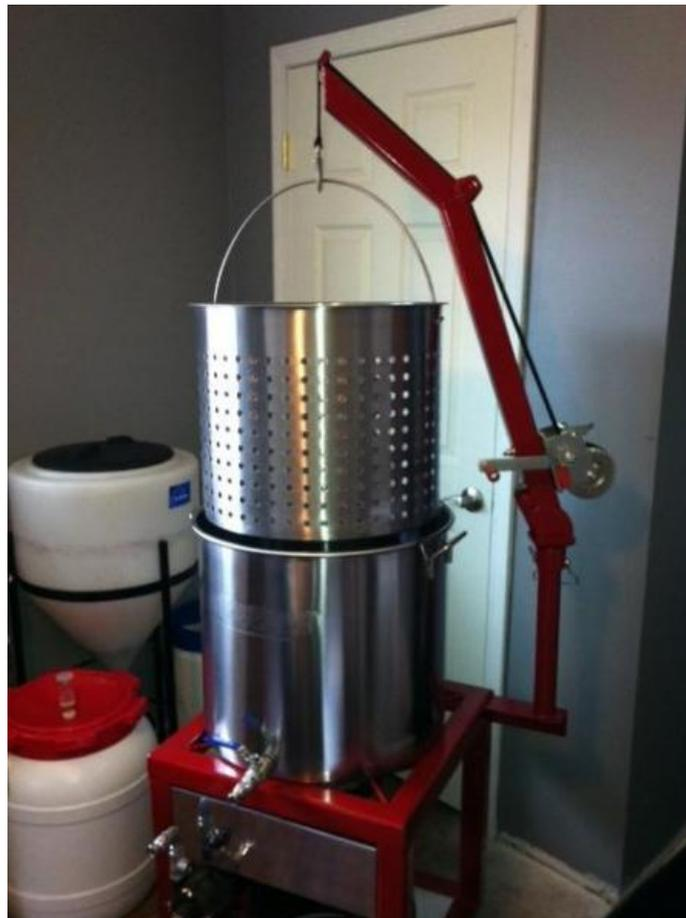
**Figura 14.** Cesto de inox, guindaste com guincho e fogão.
