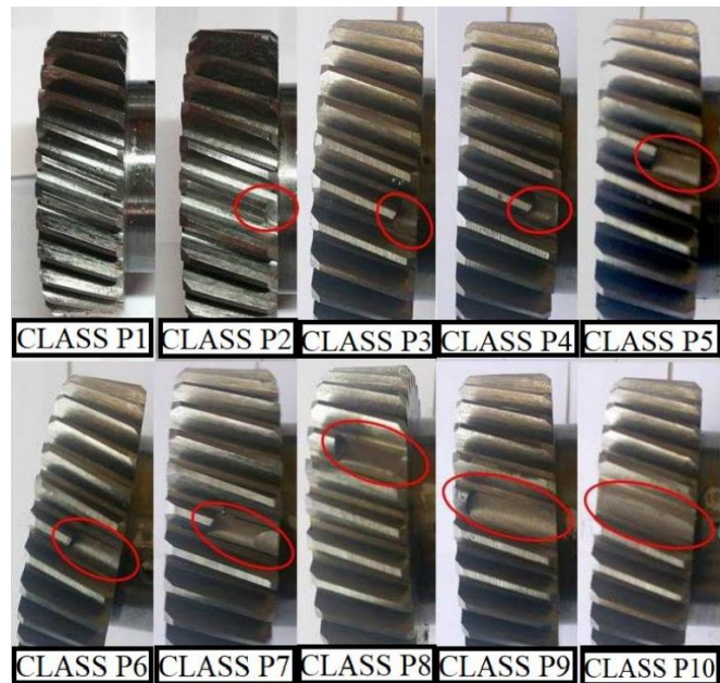
Figura 06. Aqui são apresentados os diferentes níveis de severidade na quebra dos dentes da engrenagem Z1. Extraído de [8].
