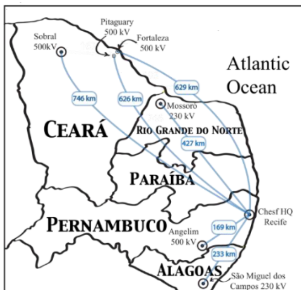
Figura 3 - Localização das torres com sistema de monitoramento de corrente de fuga
